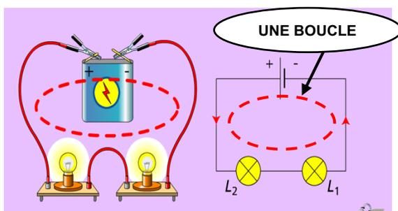
Dans un circuit en **série**, les dipôles sont branché **les uns à la suite des autres** en formant **une seule boucle**.
