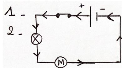
Si on inverse les bornes de la pile, le sens du moteur change.
